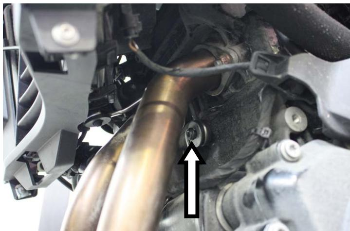
**IT** · Svitare la vite indicata e rimuovere la staffa di fissaggio radiatore
