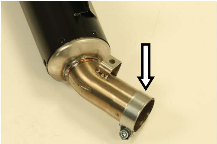
**IT** · Inserire la fascetta di serraggio nell'innesto del terminale
