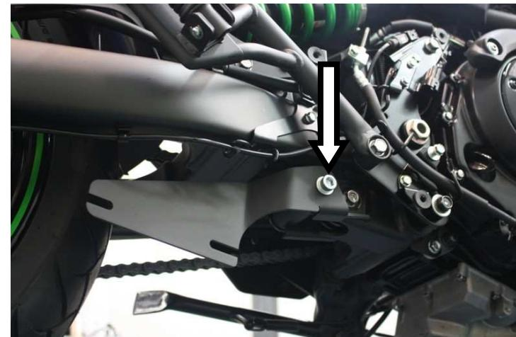
**IT** · Avvitare al telaio la staffa di sostegno terminale
